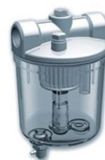
I filtri per vuoto per la separazione di liquidi della serie FSL sono particolarmente indicati per trattenere i liquidi e le particelle presenti in una rete di vuoto. L'elemento filtrante consiste in un filtro da 60 o 100 micron, realizzato in acciaio inox. La sua funzione è quella di proteggere il generatore di vuoto nelle normali condizioni di utilizzo.
