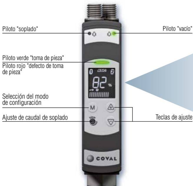
Gracias a la alta visibilidad de la pantalla LED de los módulos **LEMAX+**, todas las informaciones quedan a la vista: nivel de vacío, toma de pieza, límites alcanzados, modo de ahorro de energía activado...
