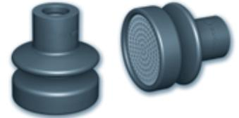
Pour répondre aux applications de préhension d'aliments souples et fragiles comme le fromage à pâte molle, COVAL a développé une ventouse 1,5 soufflets en Silicone compatible alimentaire et pouvant être équipée d'une grille inox permettant d'éviter la déformation de l'aliment.
